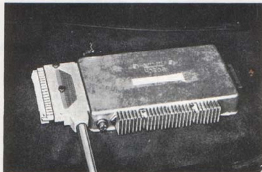
Bild 2—44. Testinstrument anslutet till ledningsmatta och styrenhet
